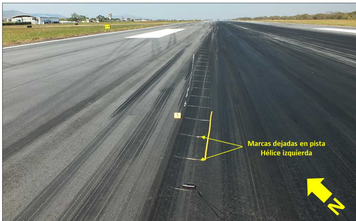
Fotografía No. 3: Marcas de las puntas de las palas de la hélice sobre la superficie asfáltica
