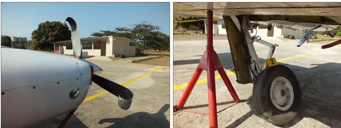
Fotografía No. 2: Condición de los daños en la hélice y tren de aterrizaje izquierdo
